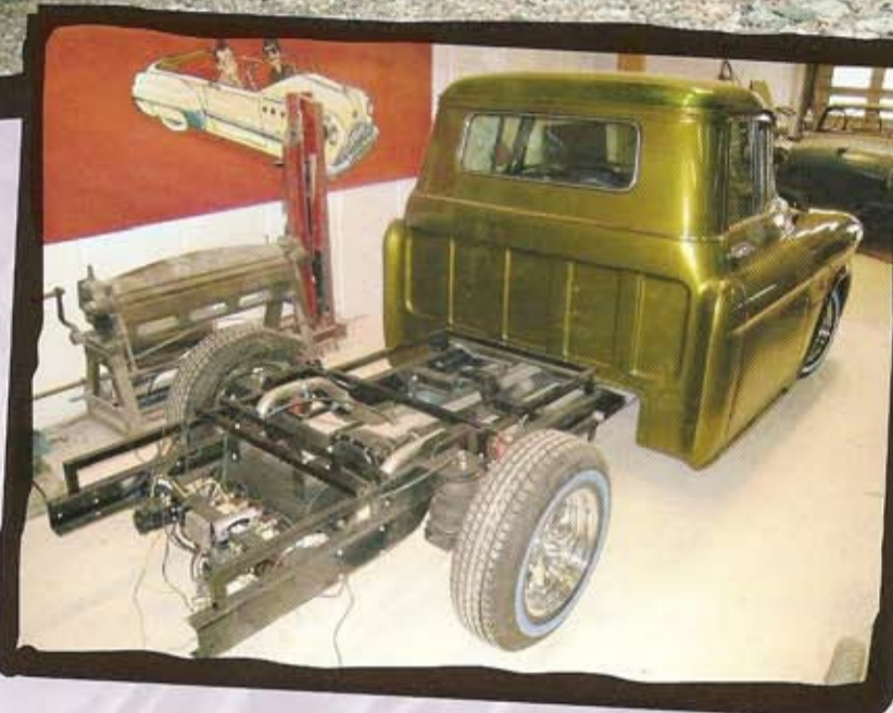
Homma alkaa olla jo votton puolella. Ilmajoustuksen painesäiliö, kompparit ja venttiilit ovat paikallaan. Lavan pohjan kehä on 12 cm alkuperäistä korkeammalla akusta, mataluuden vuoksi.
