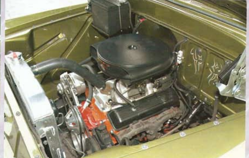
327-kuutiomainen pikkulohko on varustettu mm. Edelbrockin nelikurkkuksella kaasarella sekä Speedwayn hyvin virtaavilla valusarjoilla.
