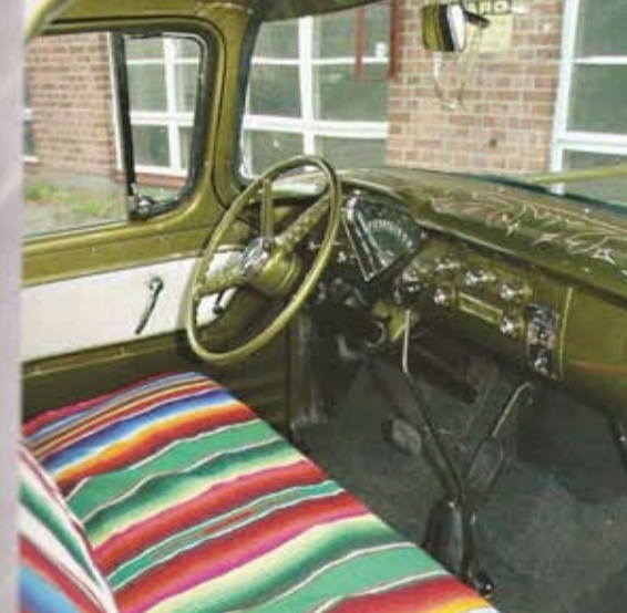
Kabinia on uusittu mm. '57-mallin koreammalla ratilla, de luxe -lämpöpörrillä ja ohjauksipaneelilla sekä Lokarin shifterillä. Helen-vaimon tikkaamat ovi- ja kattoverhoitit täydentyvät vielä samansävyisillä penkinverhoilla.
