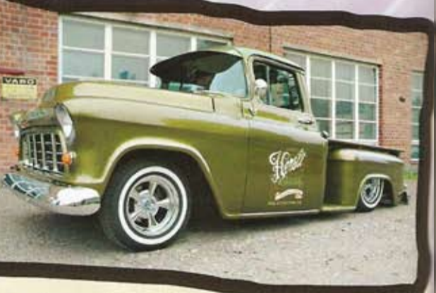
Pickupissa on aino annos low rider -henkeä sen mataluuden, ilmajoustuksen sekä rengastuksen vuoksi. Toki mitään mekaniikan suuria ripustuksia ei autoon ole lisitty. Gragarin Supreme -vanteille on pyörätetty 215-75 R 15 valkosuurenkaat.
