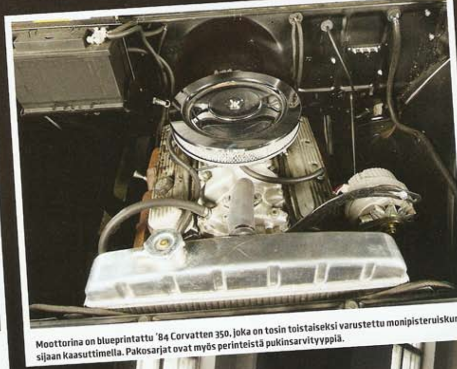
Moottorina on blueprintattu '84 Corvetten 350, joka on tosin toistaiseksi varustettu monipistekrukaan sijaan kaasuvälineillä. Pakarisarjat ovat myös perinteisiä pakisarivyyppiä.
